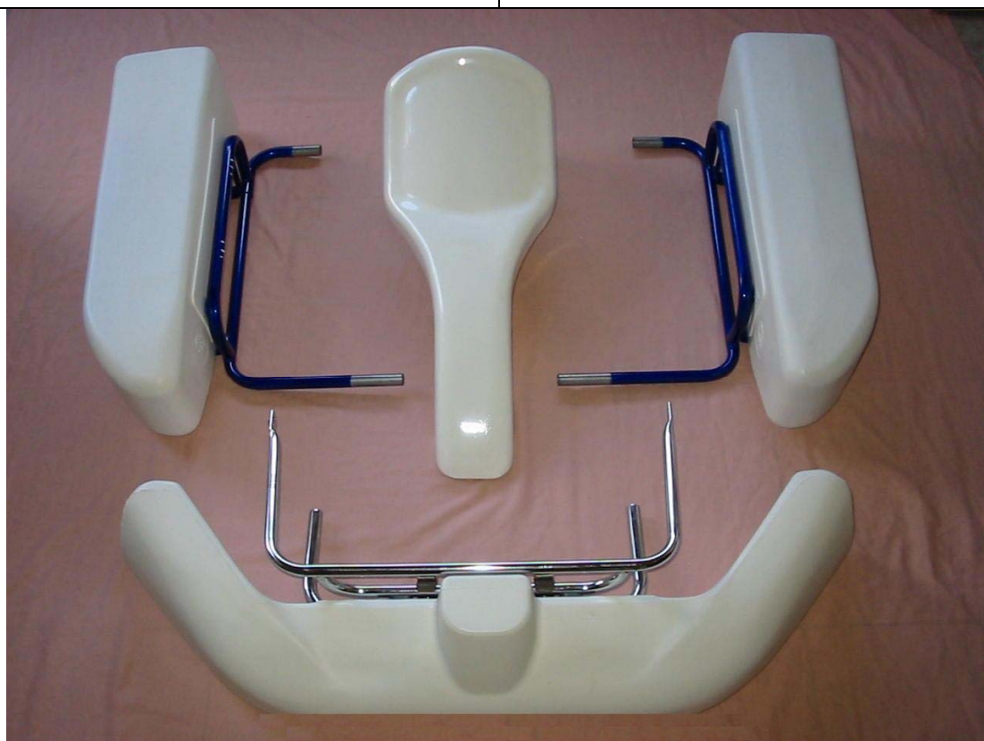
PHOTO VUE DE DESSUS DES ÉLÉMENTS DE CARROSSERIE AVEC LEURS SUPPORTS PHOTO FROM ABOVE OF BODYWORK ELEMENTS WITH THEIR SUPPORTS
